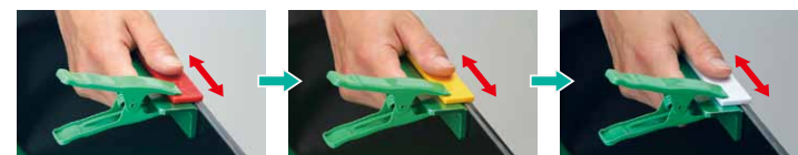
DIAFACE #200をファイルガイドにセットし、エッジを削る&磨く DIAFACE #400をファイルガイドにセットし、エッジを削る&磨く 最後に、DIAFACE #600をファイルガイドにセットし、エッジを仕上げます
