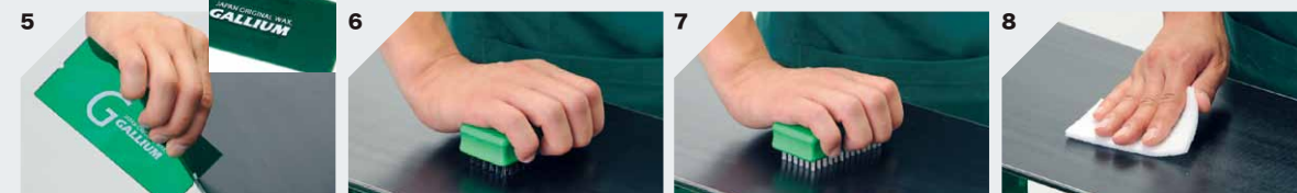
5 エッジについたワックスはスクレーパーの端の角で削ります。 6 ポアブラシでストラクチャー内の細かなワックスを掻き出します。 7 ナイロンブラシで滑走面を磨き上げます。 8 最後にファイバーテックス(最終仕上げ用)で、掻き出した細かなワックスをキレイに拭き取ります。
