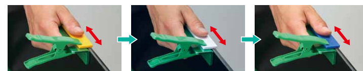
DIAFACE #400をファイルガイドにセットし、エッジを削る&磨く DIAFACE #600をファイルガイドにセットし、エッジを削る&磨く 最後に、DIAFACE #1500をファイルガイドにセットし、エッジを仕上げます
